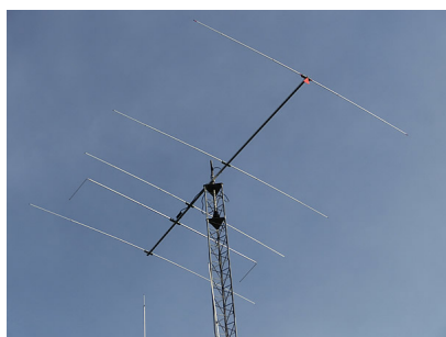
The 26-28Mhz 5el OP-DES at 21AT114
